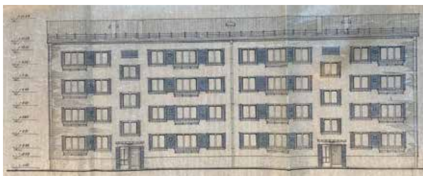
44. attēls. Tipveida projekta 1-316-2. sērijas dzīvojamās ēkas fasāde no baltiem silikāta ķieģeļiem un starpailām no sarkaniem ķieģeļiem (1958).
