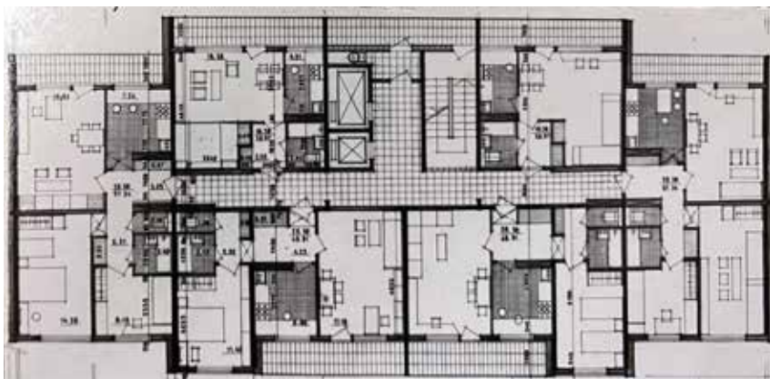
82. attēls. Tipveida projekta 104. sērijas divpadsmitstāvu dzīvojamās ēkas sekcijas 1-1-2-2-3-3 tipveida stāva plāns (20. gadsimta 70. gadi).
