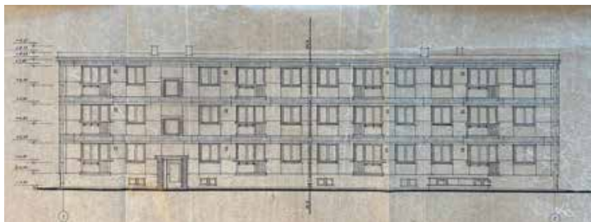
43. attēls. Tipveida projekta 1-316-1AK. sērijas dzīvojamās ēkas fasāde no lielpaneļu blokiem (1960).
